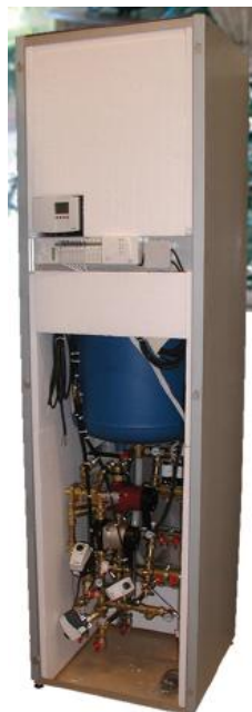
Figur 6 Foto af prototype af FVB-unit, hvor kabinet ikke er lakeret og frontpladen er afmonteret
