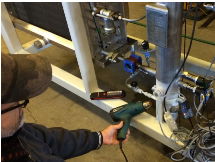
Figur 5-5: Fordampning af ammoniakvæske med varmepistol - og olie i bund af sugopot
