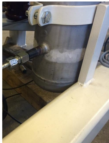
Figur 5-5: Fordampning af ammoniakvæske med varmepistol - og olie i bund af sugopot
